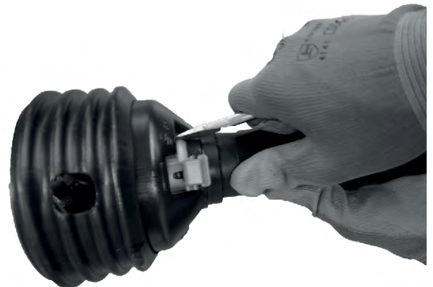
Obr. 11: Otevření krytu kloubového hřídele
