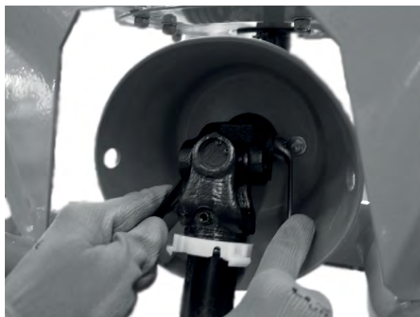
Obr. 13: Spojení kloubového hřídele
