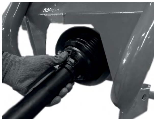
Obr. 14: Montáž krytu kloubového hřídele
