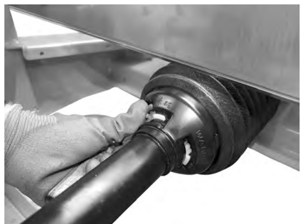
Obr. 17: Zajištění krytu kloubového hřídele
