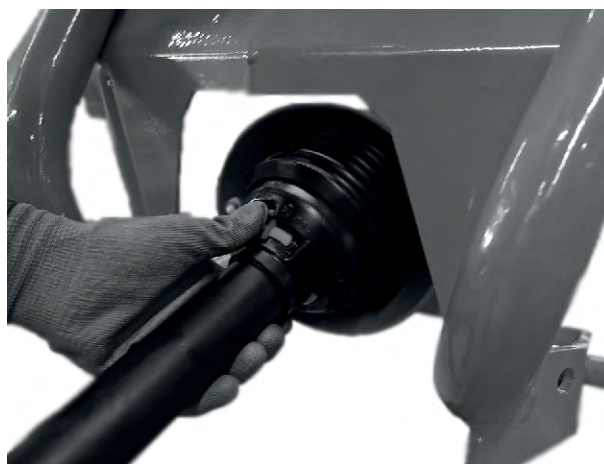
Rys. 14: Montaż osłony wału przegubowego
