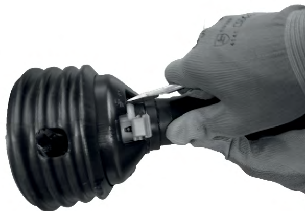
Rys. 11: Otwieranie osłony wału przegubowego
