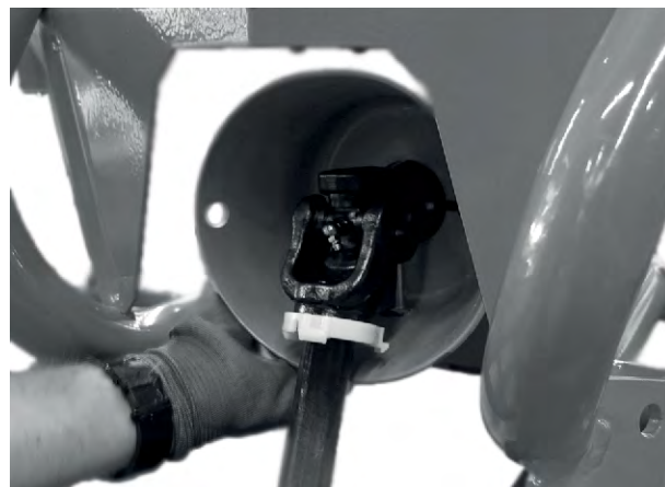
Rys. 12: Wsuwanie wału przegubowego na czop przekładni
