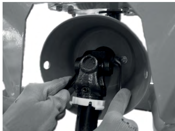
Rys. 13: Podłączanie wału przegubowego
