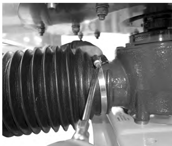
Rys. 16: Montaż osłony wału przegubowego
