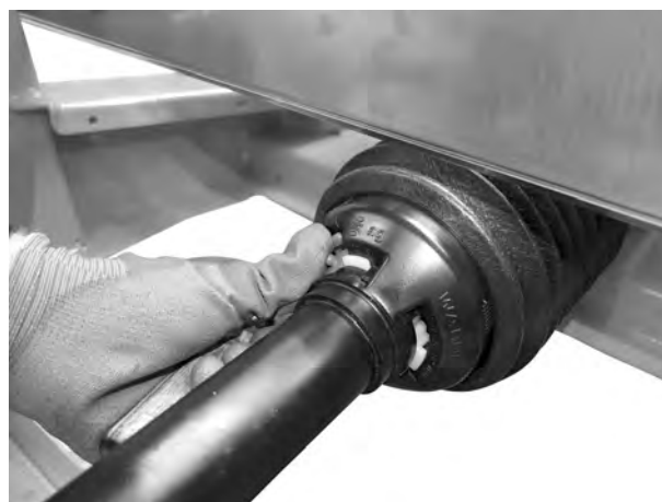
Rys. 17: Zabezpieczenie osłony wału przegubowego
