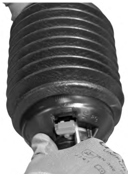
Rys. 13: Otwieranie osłony wału przegubowego
