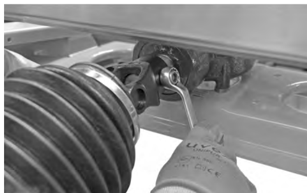
Rys. 15: Podłączenie wału przegubowego
