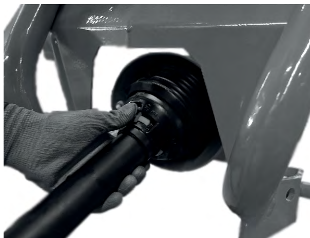
Ábr. 14: Kardántengelyvédő felhelyezése
