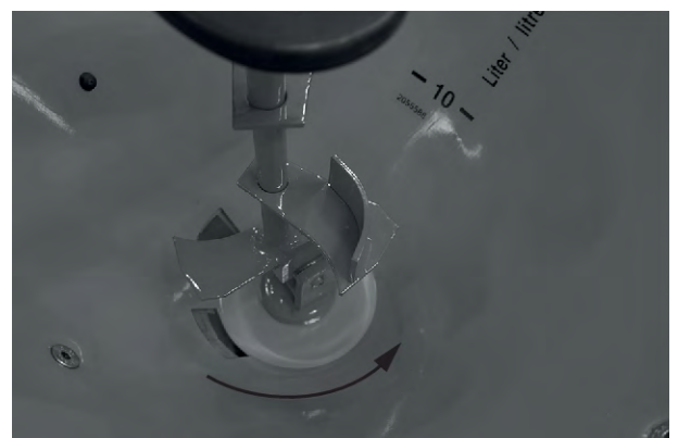
Ábr. 18: Keverőberendezés felszerelve
