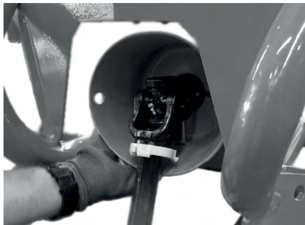
Ábr. 12: A kardántengely feltolása a hajtócsapra
