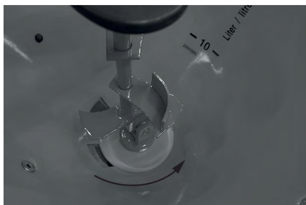
Ábr. 21: Keverőberendezés felszerelve
