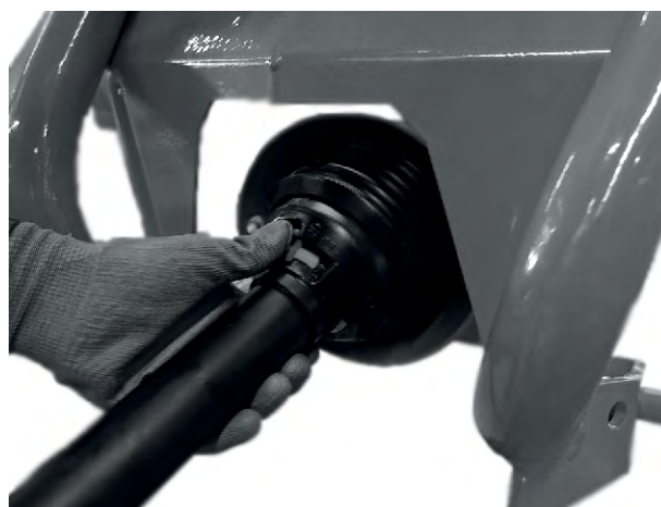
Fig. 14: Sätta dit ledaxelskyddet
