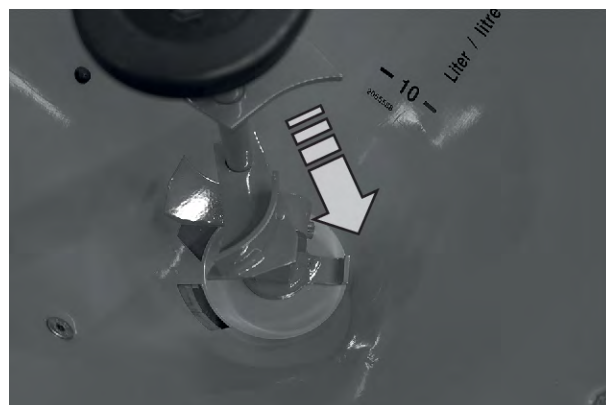
Afb. 17: Roerwerk in de voorraadbak
