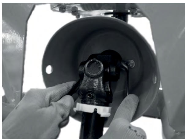
Fig. 13: Forbindelse med kardanaxslen
