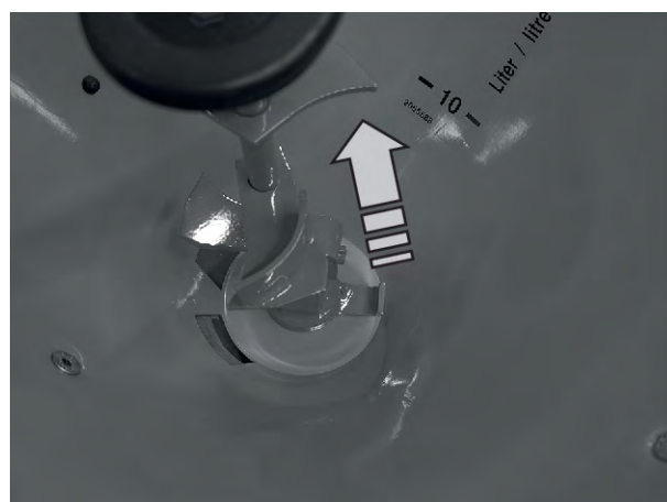
Fig. 28: Afmontering af røreværket
