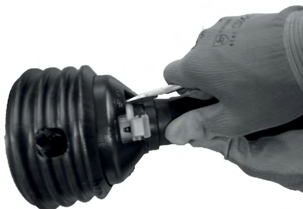
Fig. 11: Ouverture de la sécurité de l'arbre de transmission
