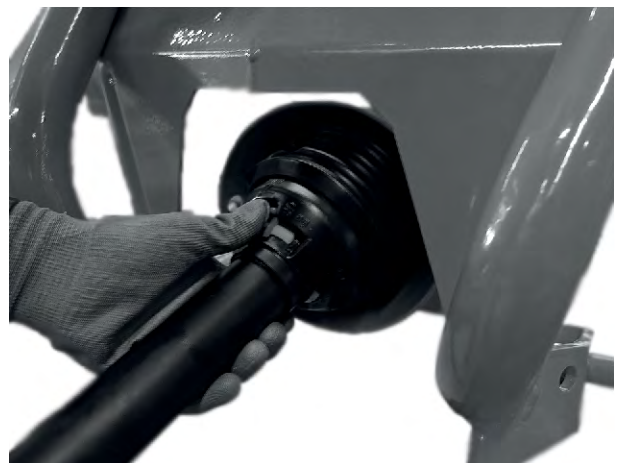
Fig. 14: Mettre la sécurité de l'arbre de transmission en place
