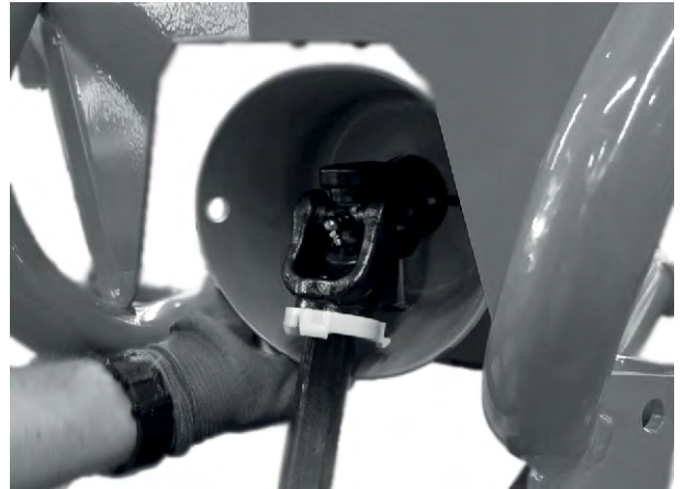
Fig. 12: Montage de l'arbre de transmission sur l'axe de l'engrenage
