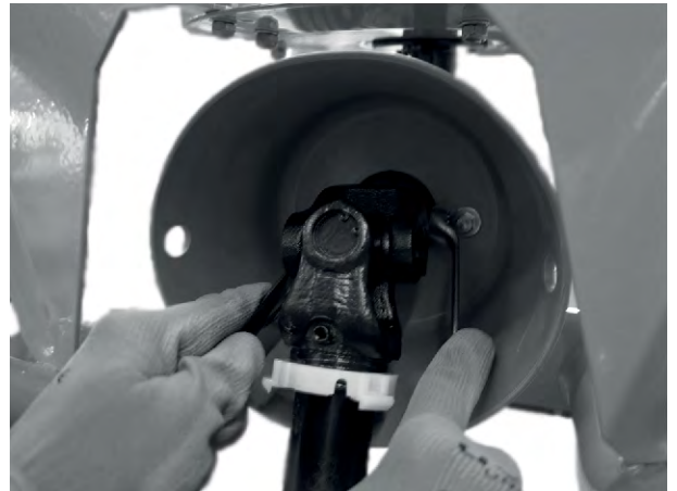
Fig. 13: Raccordement de l'arbre de transmission
