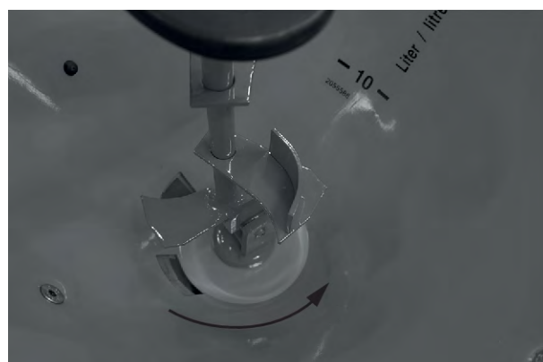
Fig. 21: Røreværket er monteret
