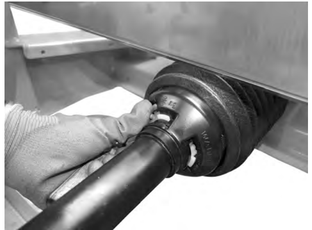
Kuva 17: Nivelakselin suojuksen varmistaminen
