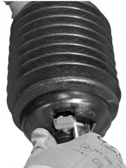
Kuva 13: Nivelakselin suojuksen avaaminen
