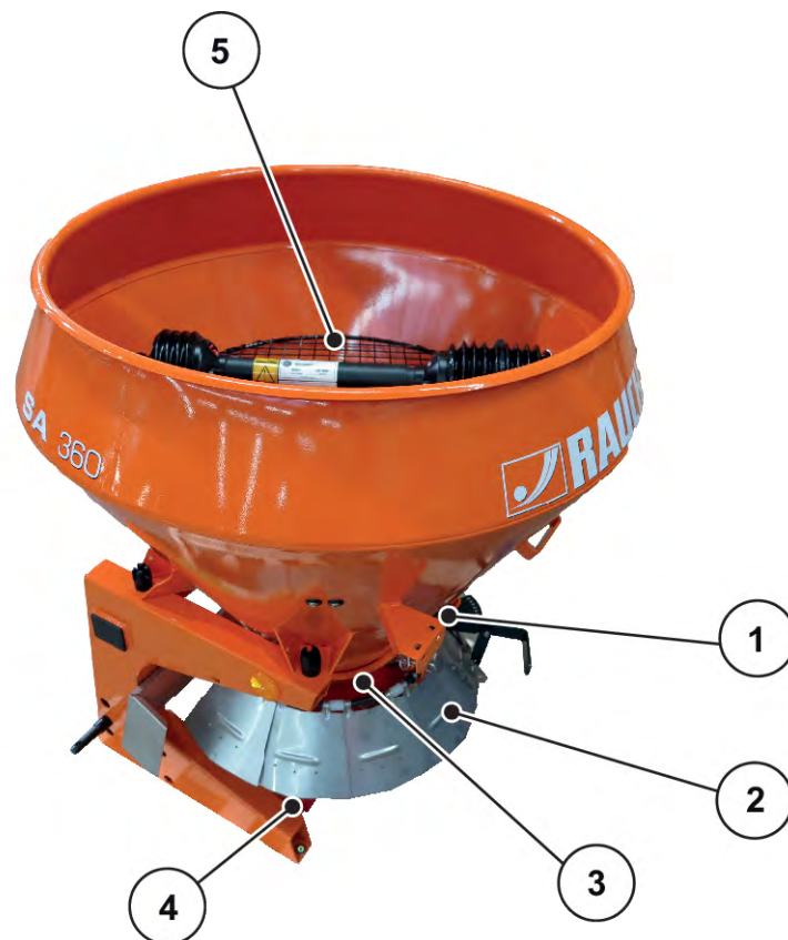
Kuva 4: Suojalaitteiden sekä varoitusten ja ohjeiden sijainti
