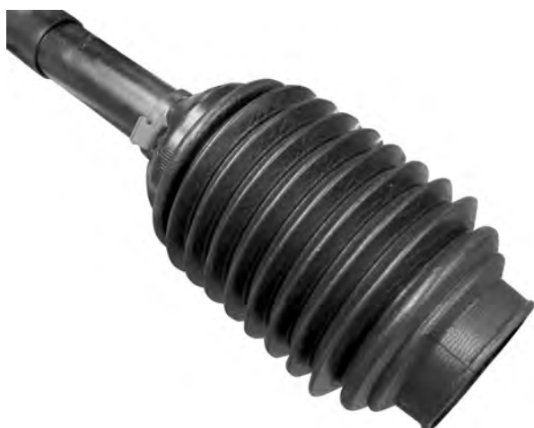
Fig. 3: Protection de l'arbre de transmission
