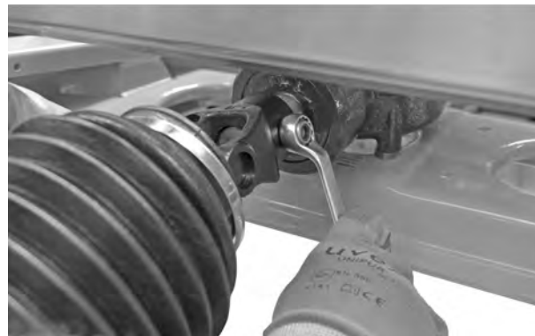
Fig. 15: Raccordement de l'arbre de transmission
