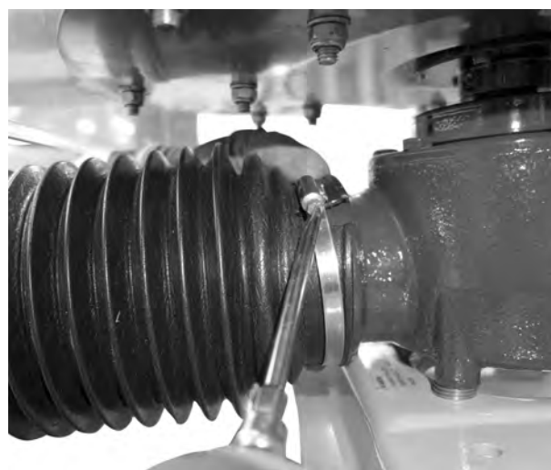
Fig. 16: Mettre la sécurité de l'arbre de transmission en place
