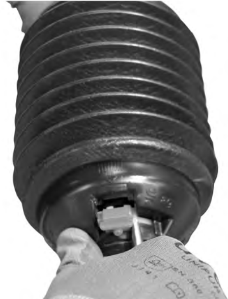
Fig. 13: Ouverture de la sécurité de l'arbre de transmission
