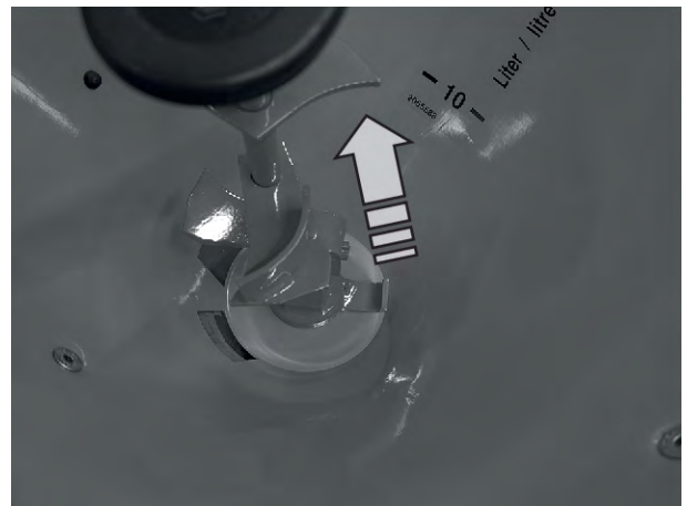
Fig. 38: Démontage de l'agitateur
