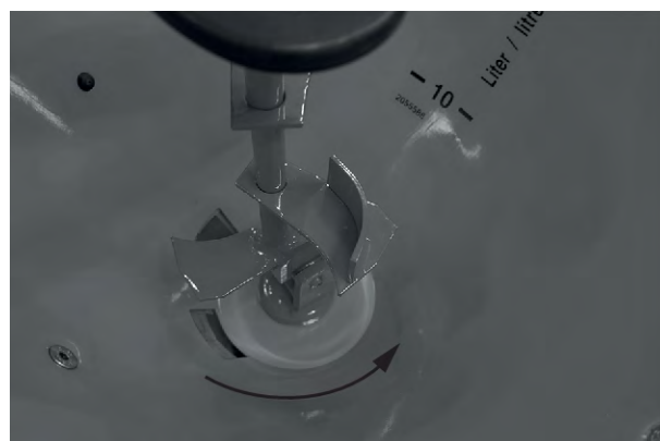
Fig. 21: Le montage de l'agitateur est terminé
