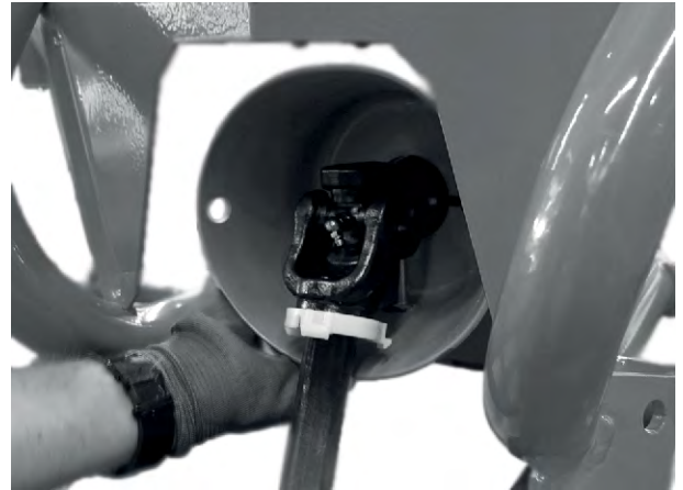
Abb. 12: Gelenkwelle auf Getriebezapfen aufstecken
