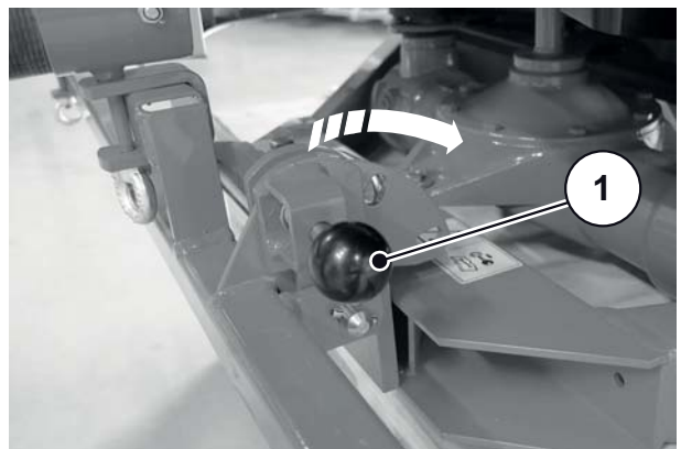
7.1 ábra: A középső rész tartókeretének elfordítása
