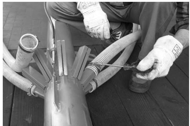
5.7 ábra: Húzza meg a tömlőrögzítő bilincseket
