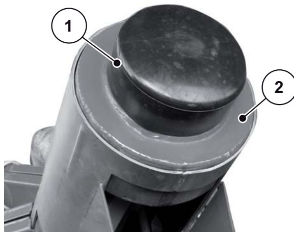
9.4 ábra: Vegye le a csőlezáró sapkát
