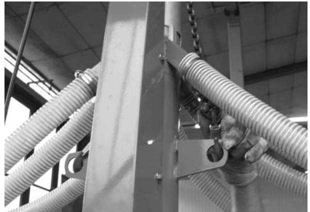
9.1 ábra: Helyezze az emelőt a csigacsőre
