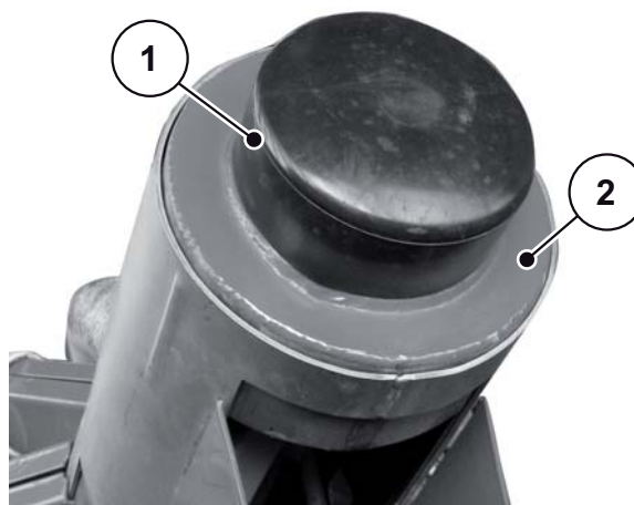
Rysunek 9.4: Zdejmowanie klapy zamykającej rurę
