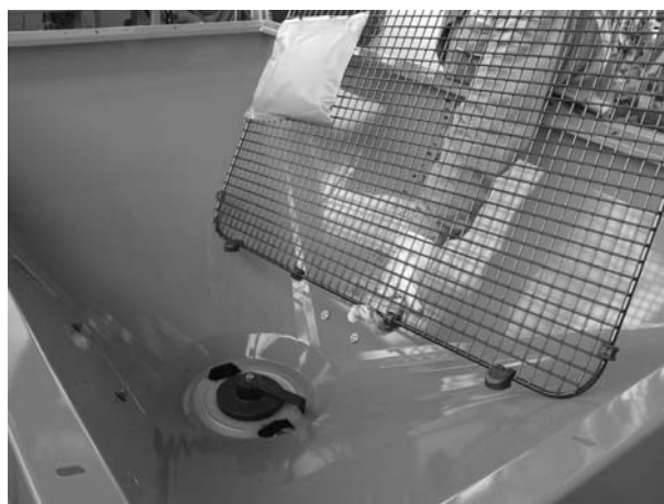
Rysunek 5.3: Zdjąć kratkę ochronną
