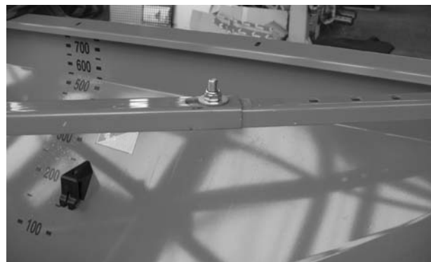
Bild 5.15: Mittelteil der Verstrebung befestigen
