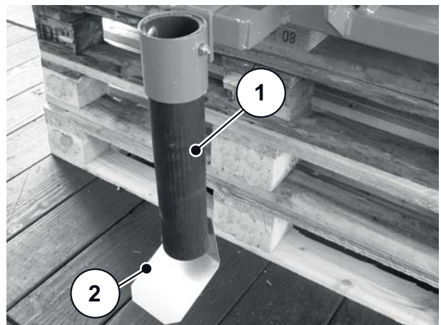
Bild 5.22: Mittleres Ablaufrohr montieren
