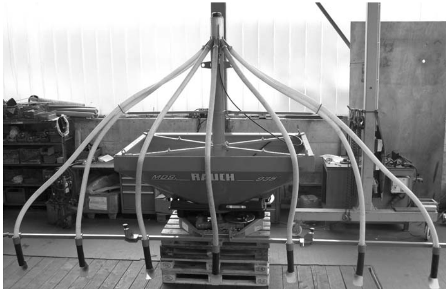
Bild 5.25: Reihendüngerungsgerät auf einem MDS-Düngerstreuer montiert
