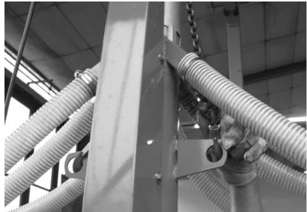
Bild 9.1: Hebezeug am Schneckenrohr anlegen
