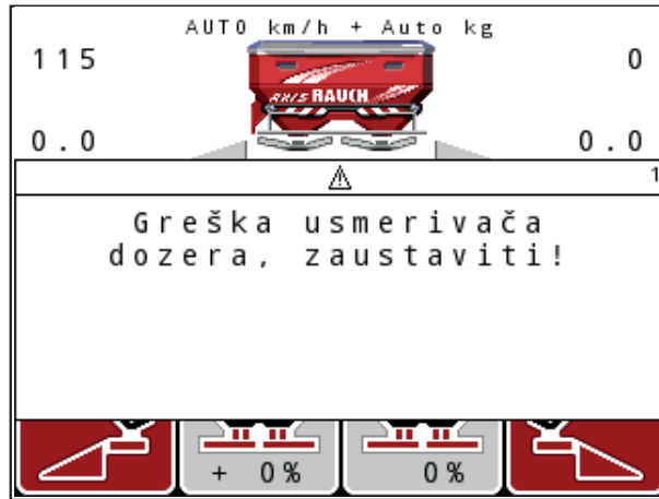
Slika 6.1: Poruka o alarmu (primer uređaja za doziranje)
