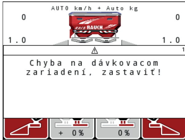
Obrázok 6.1: Alarmové hlásenie (príklad dávkovacieho zariadenia)
