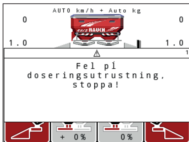
Bild 6.1: Larmmeddelande (exempel doseringsutrustning)
