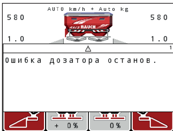
Рис. 59: Пример аварийного сообщения
