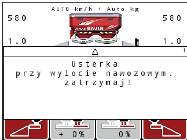
Rys. 58: Przykłady komunikatów alarmowych
