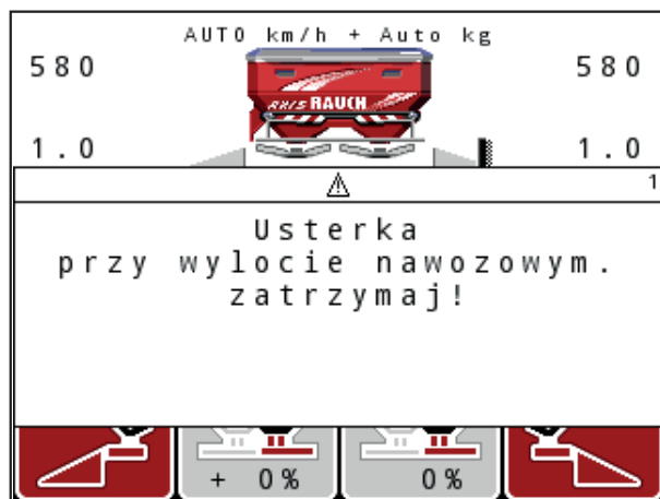
Rysunek 6.1: Komunikat alarmowy (na przykładzie urządzenia dozującego)
