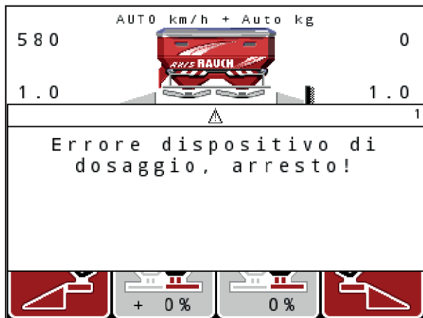
Ill. 59: Esempio di messaggio di allarme
