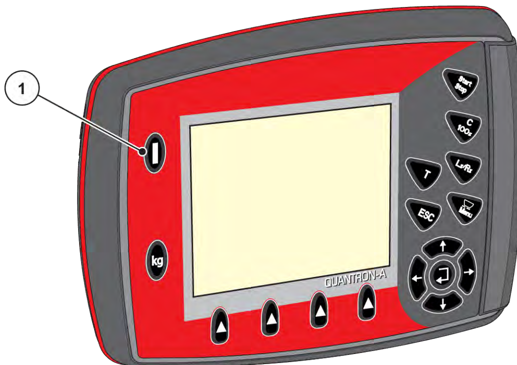
Fig. 16: Mise en marche de l'unité de commande
