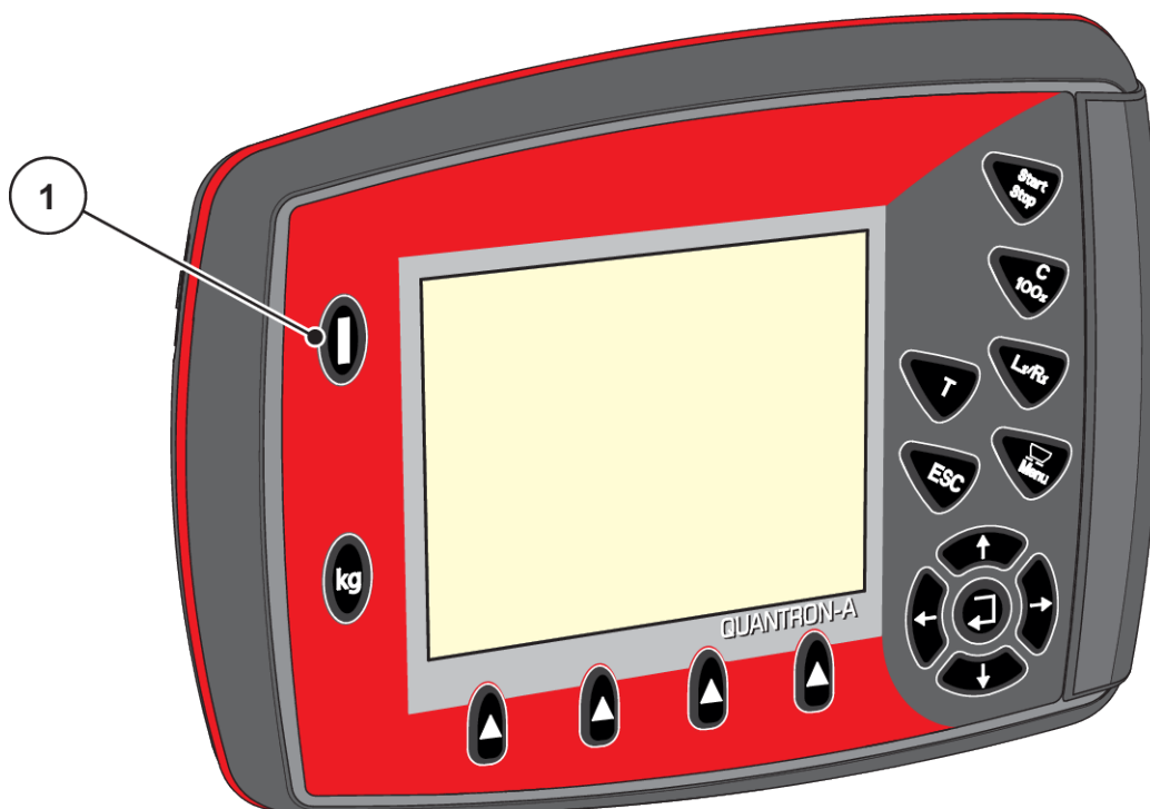
Fig. 16: Mise en marche de l'unité de commande
