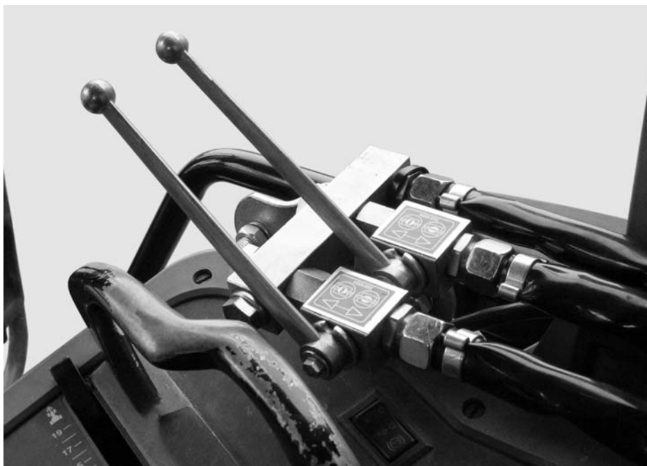
Мал. 7.12: Гідравлічний пристрій керування заслінкою двоходового блока За допомогою кульових кранів двоходового блока можна окремо керувати заслінками дозатора.
