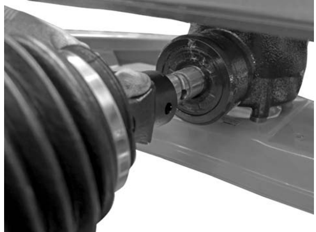
Мал. 7.2: Установлення карданного вала на цапфу редуктора
