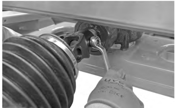
Obr. 13: Pripojenie kĺbového hriadeľa
