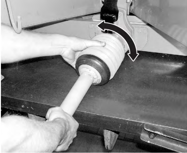
Obr. 20: Založenie ochranného krytu kĺbového hriadeľa
