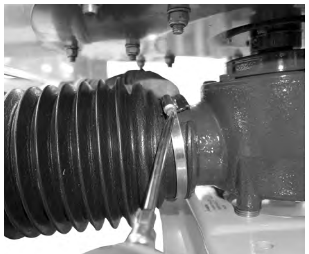
Obr. 14: Nasadenie ochranného krytu kĺbového hriadeľa
