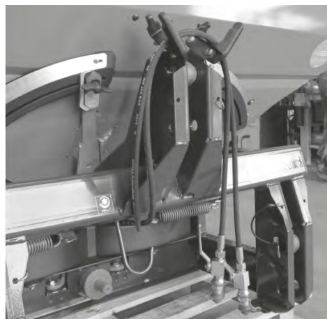
Obr. 62: Odloženie kľbového hriadeľa, odloženie káblov a hydraulických hadíc
