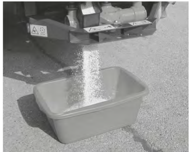
Obr. 37: Vykonanie skúšobného rozmetávania
