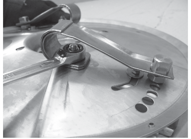
Şek. 86: Cıvatanın çıkarılması
