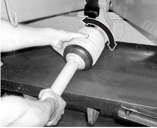
Şek. 20: Tahrik mili korumasının yerleştirilmesi
