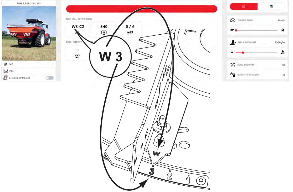
Şek. 42: Fırlatma kanadı ayarı, fırlatma diski M2, ayar W3; W: sabit uzunluk ayarı 1 ila 6: Açık ayarı
