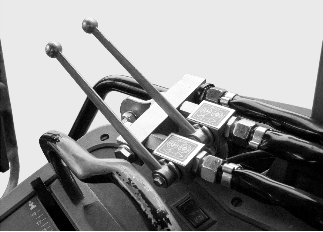
Şek. 28: İki yönlü ünitenin sürgü işletim tertibatı
