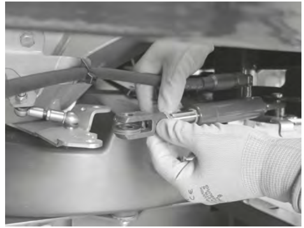
Şek. 71: Hidrolik silindirin çekip çıkarılması
