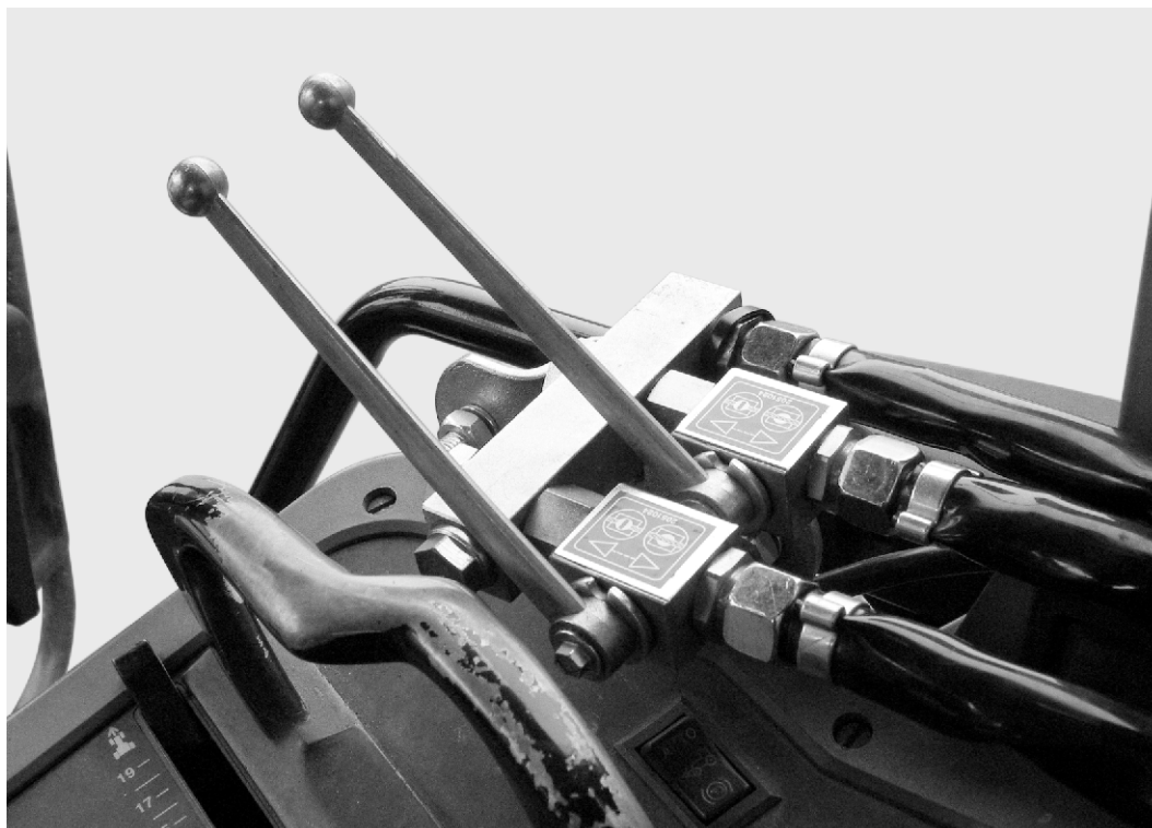
Σχ. 28: Μηχανισμός ενεργοποίησης δικλείδων της δίοδης μονάδας
