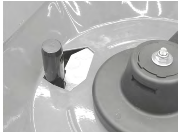
Σχ. 68: Μπουλόνι κάτω συνδέσμου μέσα στο δοσομετρικό άνοιγμα
