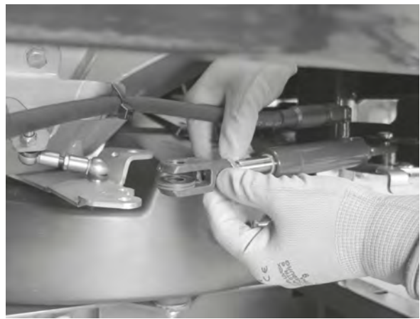
Σχ. 71: Τράβηγμα έξω του υδραυλικού κυλίνδρου
