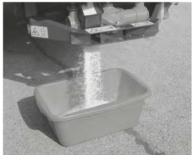
Σχ. 37: Εκτέλεση δοκιμής βαθμονόμησης
