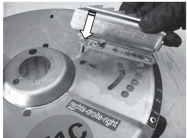
Σχ. 90: Συναρμολόγηση κύριου πτερυγίου
