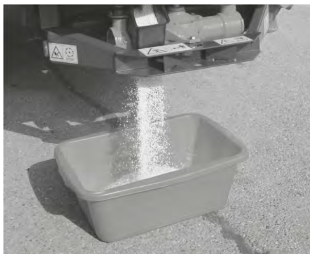
Ábr. 37: Leforgatási próba végrehajtása
