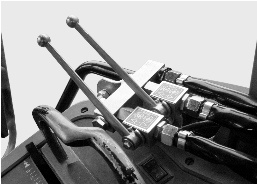
Ábr. 28: Kétutas szelep tolózárvezérlése
