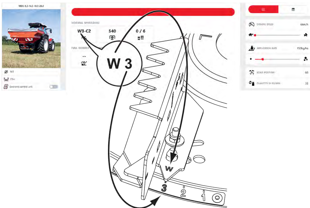
Ábr. 42: Szórólapát-beállítás M2 szórótárcsa, W3 állás; W: fix hosszbeállítás 1 – 6: Szögbeállítás
