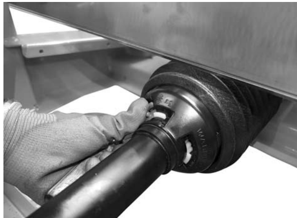
7.5 ábra: A kardántengely-védelem rögzítése
