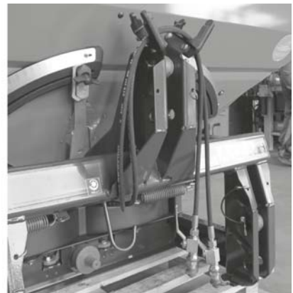
7.14 ábra: A kardántengely és a hidraulikus tömlők tárolása
