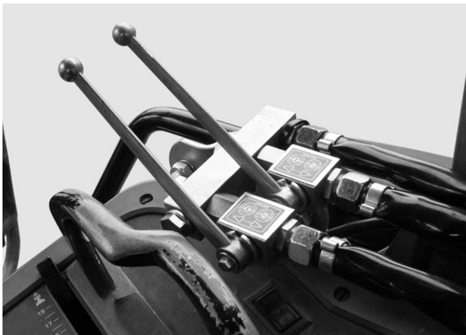
7.12 ábra: Kétutas szelep tolózárvezérlése
