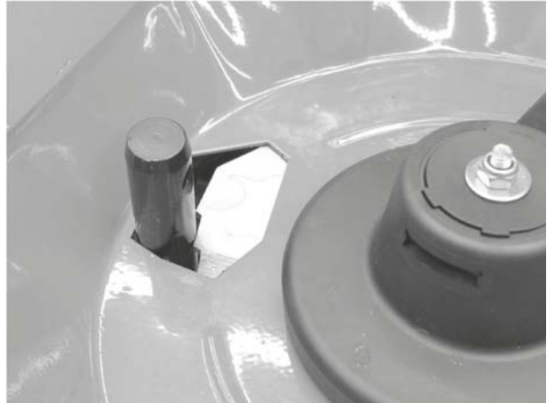
12.5 ábra: Alsó összekötőcsap az adagolónyílásban
