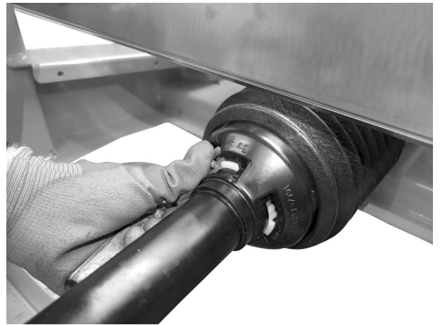
Fig. 15: Säkra kraftöverföringsaxelns skydd
