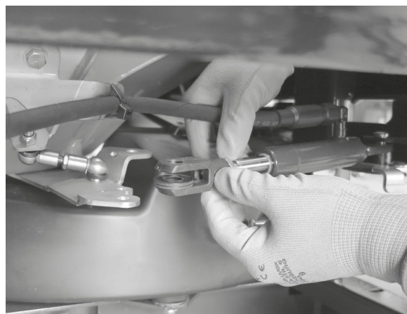
Fig. 71: Dra ut hydraulcylinder
