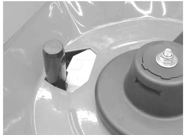
Fig. 68: Nedre ledarmens bult i doseringsöppning
