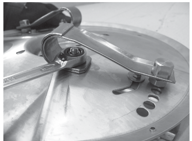
Fig. 94: Fästa den plana fjädern
