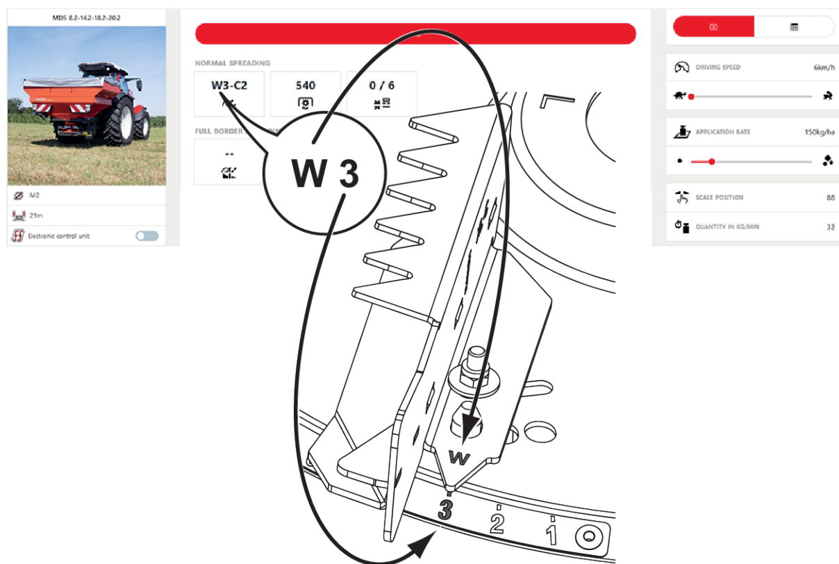
Fig. 42: Inställning av spridarvingar, spridarvinge M2, läge W3; W: fast längdinställning 1 till 6: Vinkelinställning
