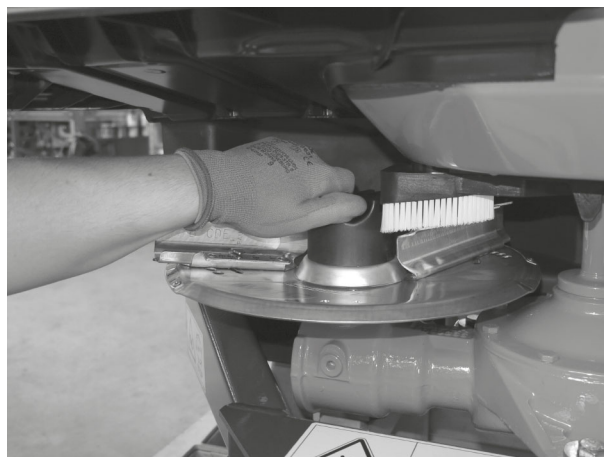
Fig. 38: Skruva dit hattmuttern
