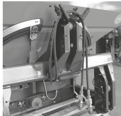
Fig. 62: Kraftöverföringsaxelns förvaring, kablarnas förvaring och hydraulslangar
