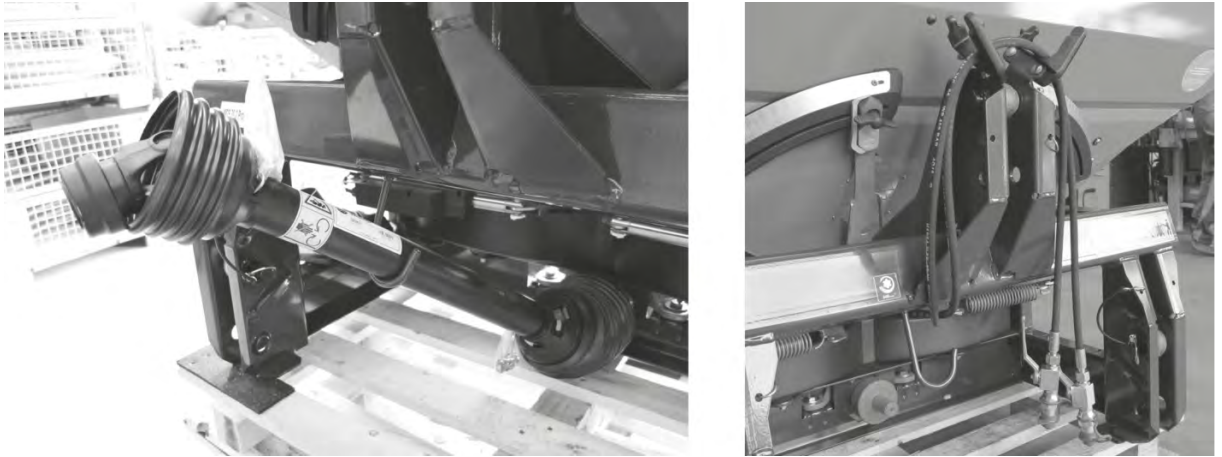
Fig. 62: Legg ned kardangakselen, legg ned kabel og hydraulikkslanger
