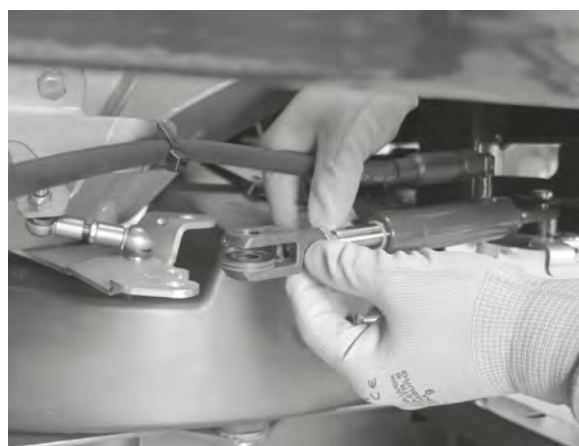
Fig. 71: Trekk ut den hydrauliske sylinderen
