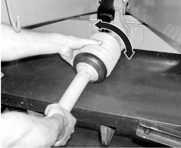
Fig. 20: Legg an kardangakselbeskyttelsen
