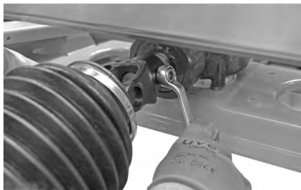
Fig. 13: Koble til kardangakselen
