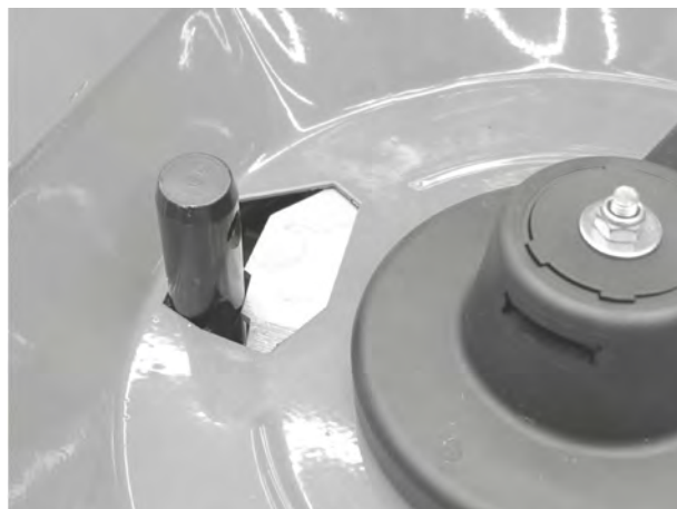
Fig. 68: Trekkstangbolt i doseringsåpning
