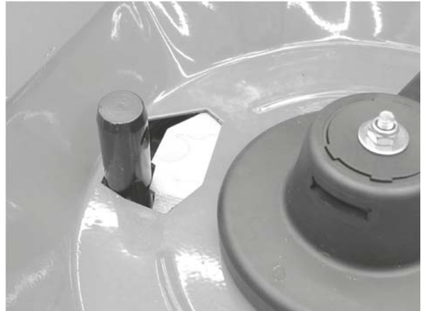
Bilde 12.5: Trekkstangbolt i doseringsåpning
