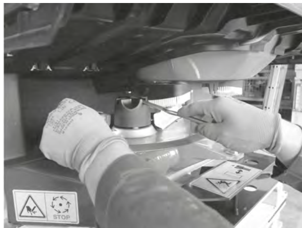
Sl. 76: Otpuštanje zaobljene slijepa matice
