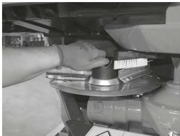
Sl. 38: Pričvršćivanje zaobljene slijepa matice
