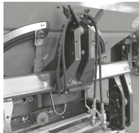
Sl. 62: Mjesto za odlaganje kardanskog vratila, mjesto za odlaganje kabela i hidrauličnih crijeva
