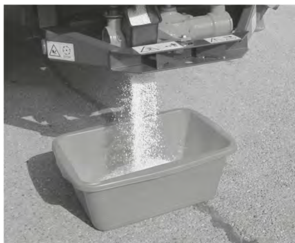
Fig. 37: Efectuarea unei calibrări
