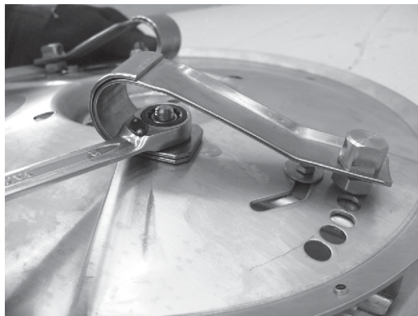
Ilust. 86: Remover os parafusos
