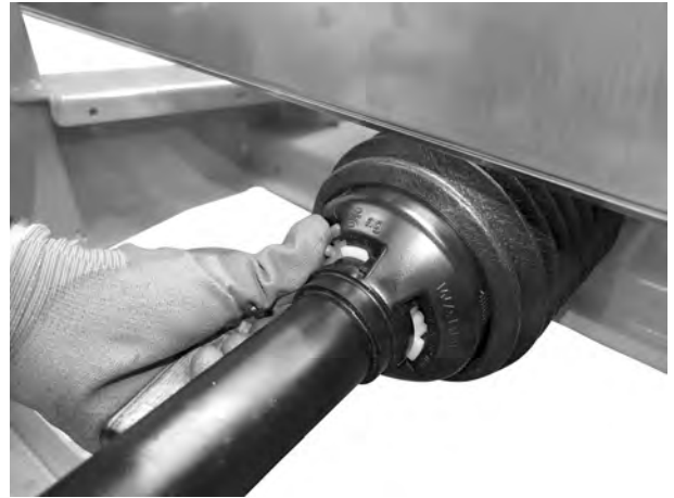
Ilust. 15: Fixar a proteção do eixo articulado
