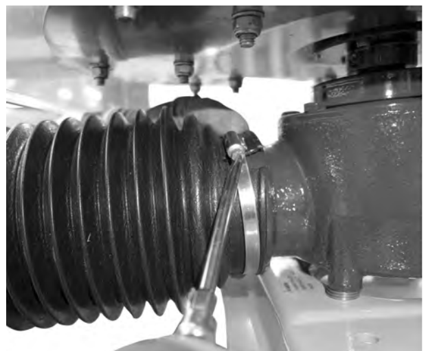
Ilust. 14: Colocar a proteção do eixo articulado
