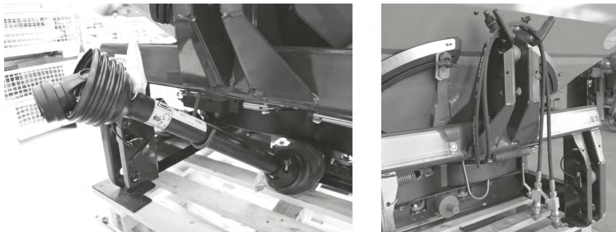
Ilust. 62: Apoio do eixo articulado, apoio dos cabos e mangueiras hidráulicas
