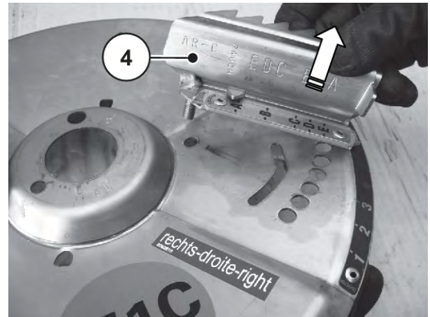
Rys. 89: Demontaż łopatki rozrzucającej
