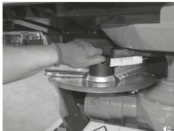
Rys. 38: Przykręcanie nakrętki kołpakowej
