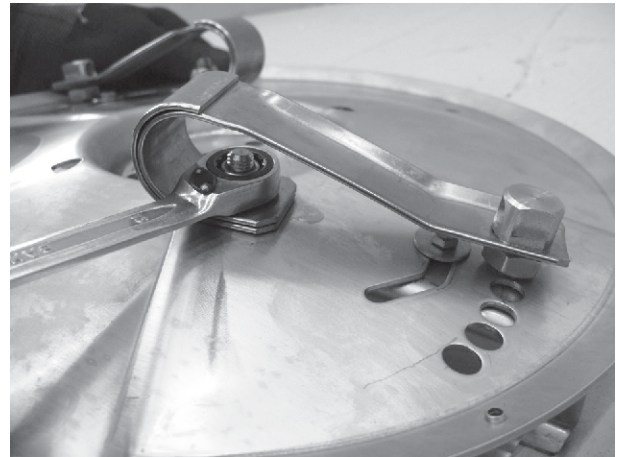
Rys. 94: Mocowanie sprężyn płaskich
