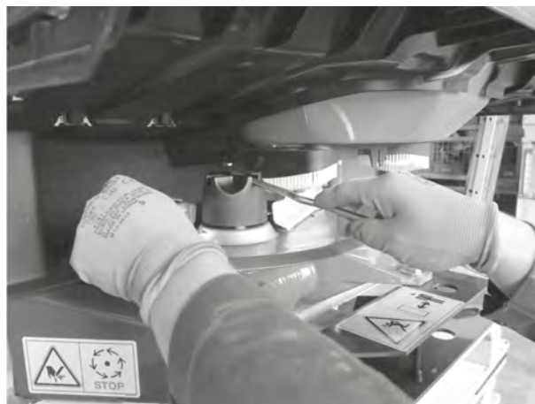
Rys. 35: Luzowanie nakrętki kołpakowej
