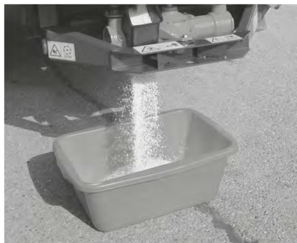
Rys. 37: Wykonanie próby rozsiewu
