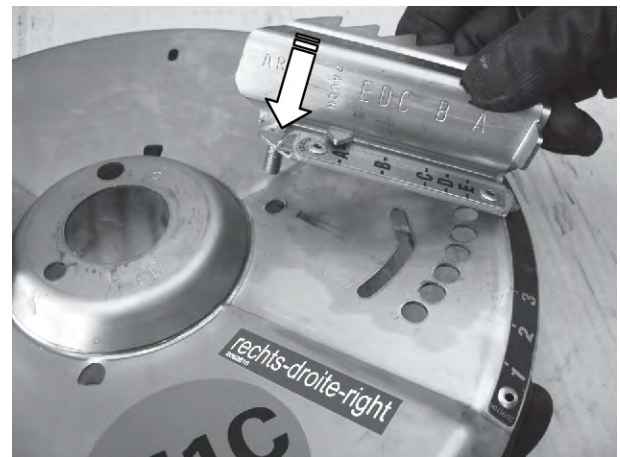
Rys. 90: Montaż łopatki głównej
