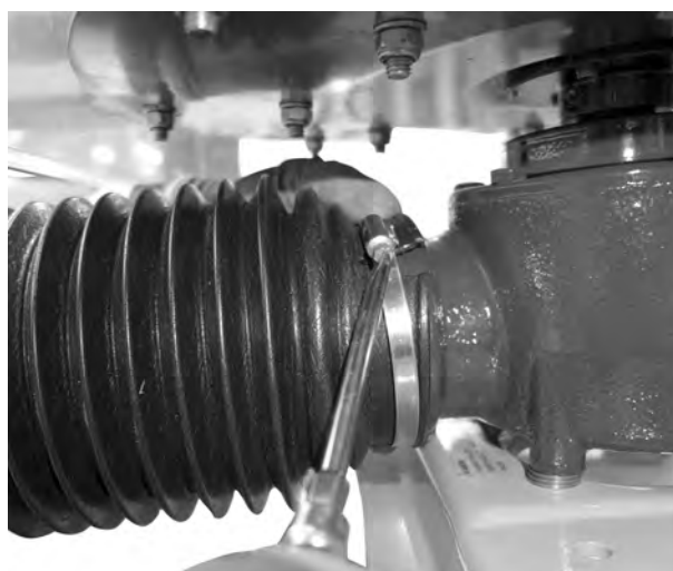
Rys. 14: Montaż osłony wału przegubowego
