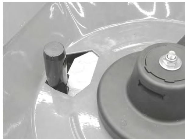
Rys. 68: Trzpień dolnego ramienia podnośnika w otworze dozującym
