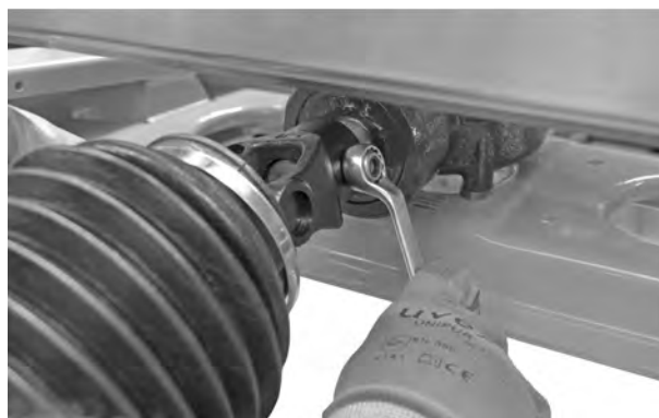
Rys. 13: Podłączanie wału przegubowego
