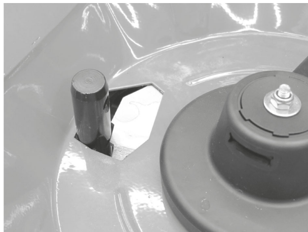
Rys. 68: Trzpień dolnego ramienia podnośnika w otworze dozującym
