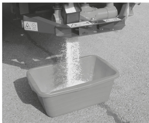
Rys. 37: Wykonanie próby rozsiewu
