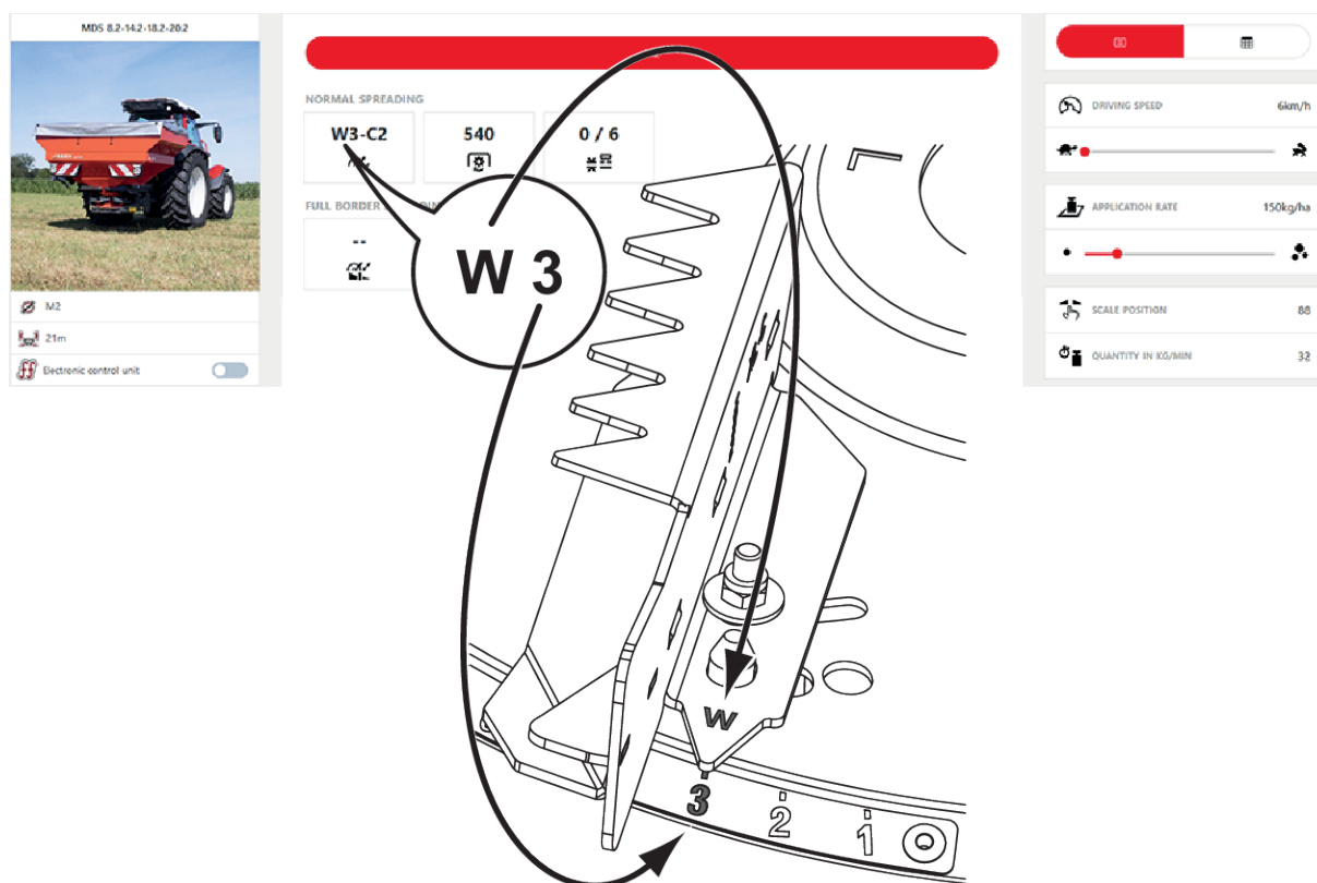
Rys. 42: Ustawianie łopatek tarczy rozrzucającej M2, położenie W3; W: stałe ustawienie długości 1 do 6: Ustawianie kąta
