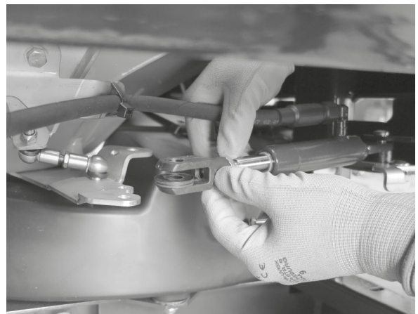
Rys. 71: Wysuwanie siłownika hydraulicznego
