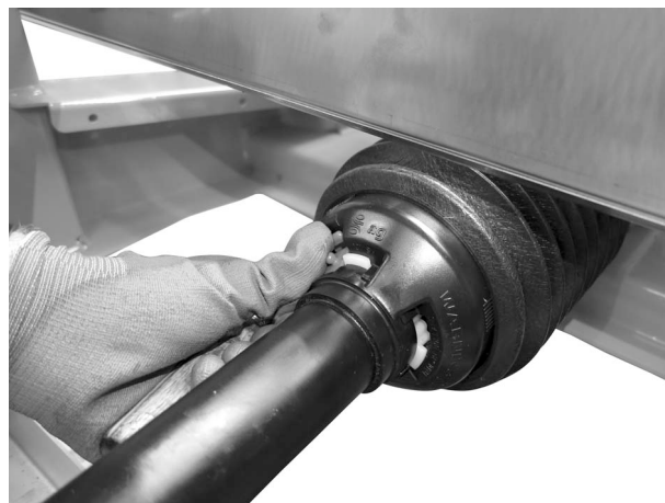
Rys. 15: Zabezpieczenie osłony wału przegubowego
