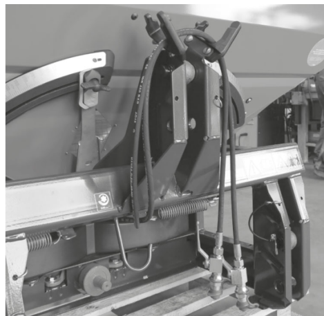
Rys. 62: Schowek na wał przegubowy, schowek na kable i giętkie przewody hydrauliczne
