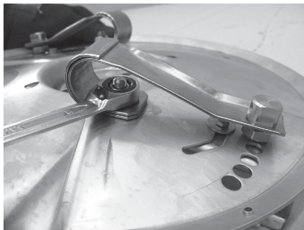
Rys. 94: Mocowanie sprężyn płaskich
