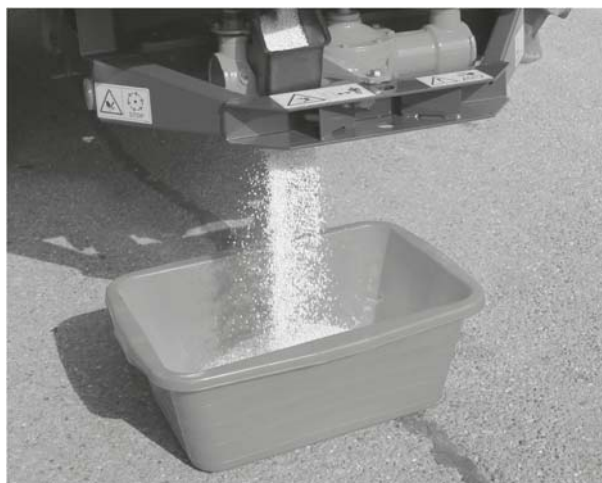
Rysunek 9.7: Przeprowadzenie próby kręconej
