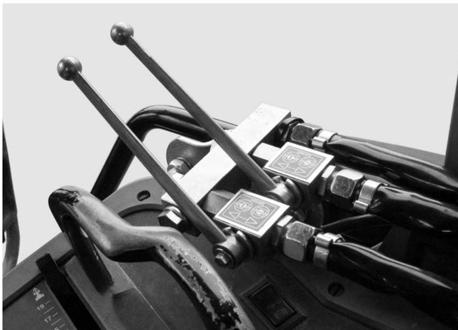
Rysunek 7.12: Układ sterowania zasuwami jednostki dwudrożnej
