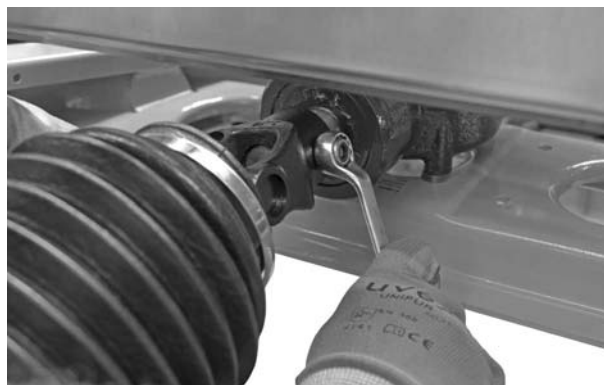
Rysunek 7.3: Podłączanie wału przegubowego
