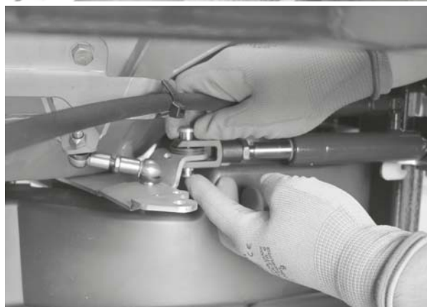
Rysunek 12.7: Odczepianie siłownika
