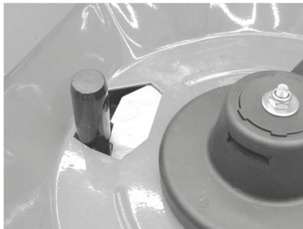
Rysunek 12.5: Trzpień dolnego ramienia podnośnika w otworze dozującym
