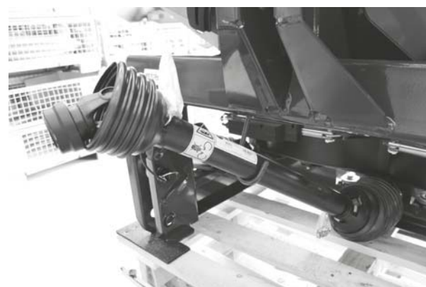
Rysunek 7.6: Mocowanie wału przegubowego
