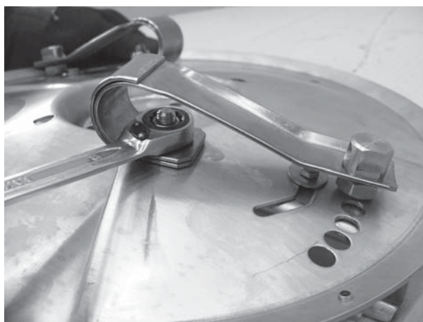
Rysunek 12.22: Wyjmowanie śrub
