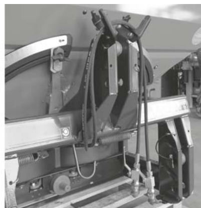
Rysunek 7.14: Miejsce do przechowywania wału przegubowego i przewodów hydraulicznych
