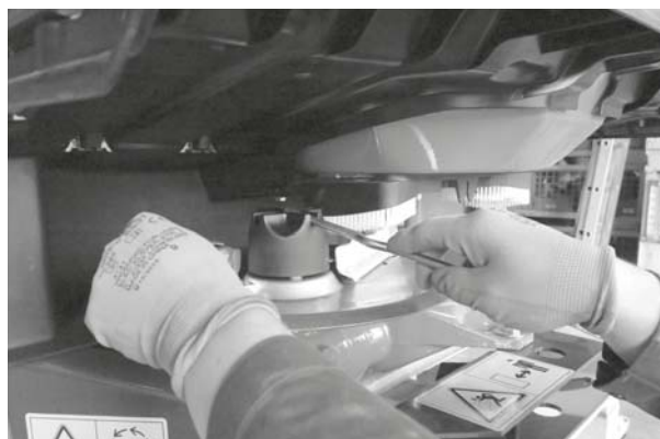
Rysunek 12.13: Luzowanie nakrętki kołpakowej
