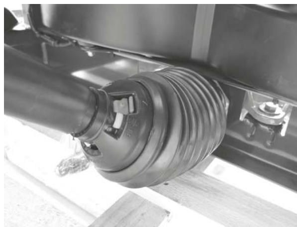
Rysunek 3.4: osłona wału przegubowego.
