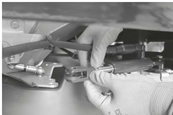
Rysunek 12.8: Wymowanie siłownika hydraulicznego
