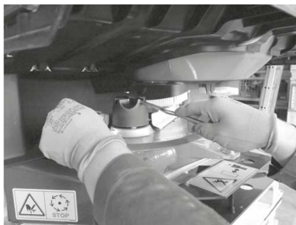
Rysunek 9.5: Luzowanie nakrętki kołpakowej
