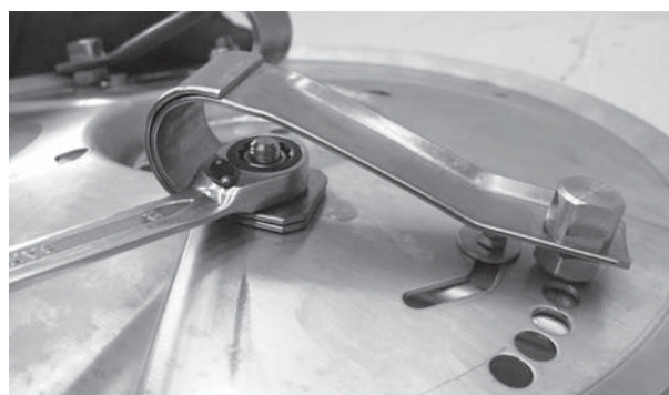
Rysunek 12.30: Mocowanie sprężyn powierzchniowych
