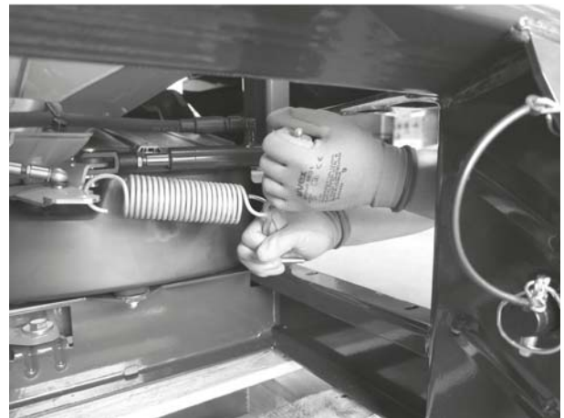
Rysunek 12.6: Odczepianie sprężyny
