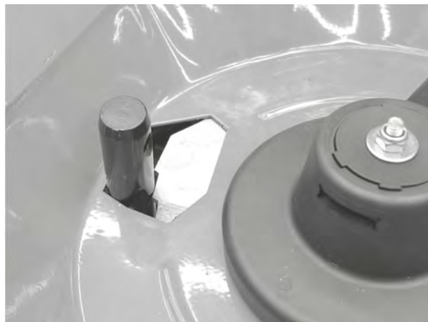
Att. 68: Apakšējās sviras tapa dozēšanas atverē
