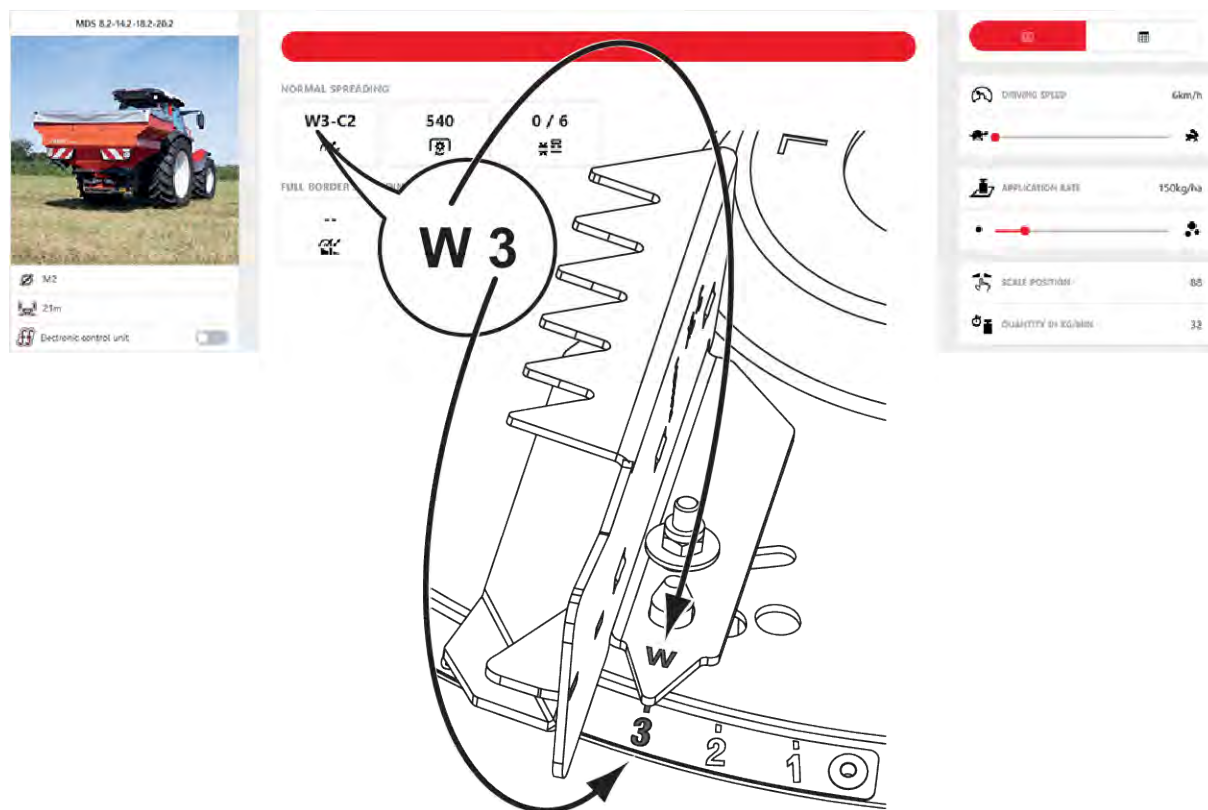
Att. 42: Izmetējlapstiņas iestatīšana, izkliedēšanas disks M2, pozīcija W3; W: fiksēts garuma iestatījums no 1 līdz 6: Leņķa iestatījums
