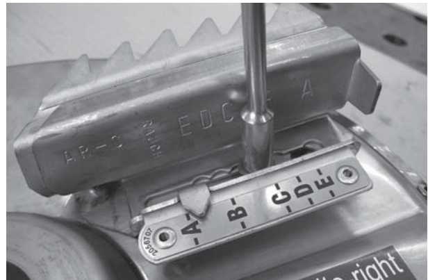
12.27. attēls: Izkļiedēšanas diska izsviedējlāpstiņas
