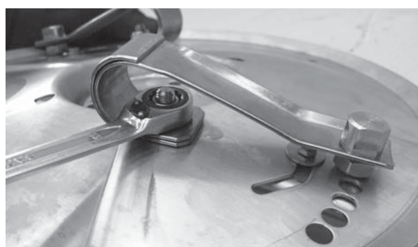
12.30. attēls: Plakanatsperu nostiprināšana
