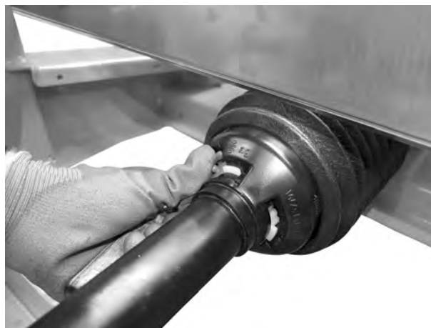
Pav. 15: Kardaninio veleno apsaugo užfiksavimas
