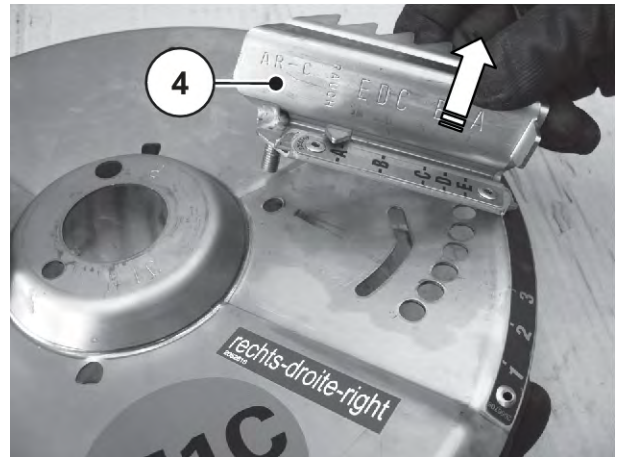
Pav. 89: Barstomosios mentės išėmimas
