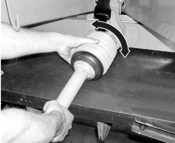
Pav. 20: Kardaninio veleno apsaugo uždėjimas
