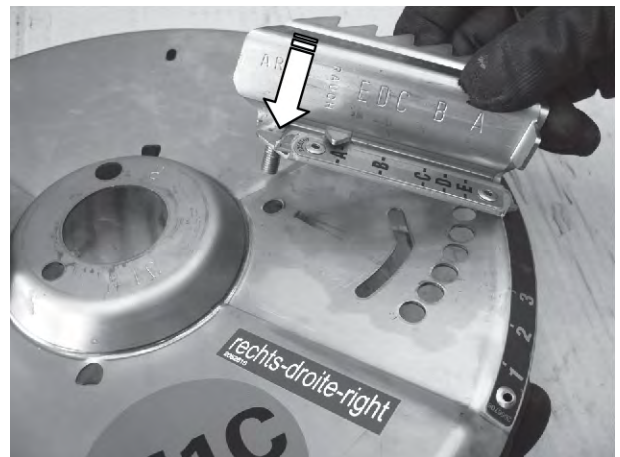
Pav. 90: Pagrindinės mentės montavimas
