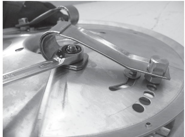
Pav. 94: Plokščiosios spyruoklės tvirtinimas
