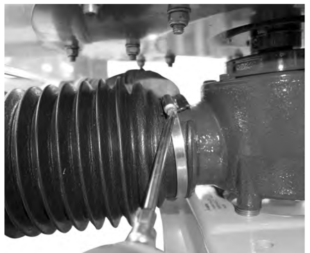
Pav. 14: Kardaninio veleno apsaugo uždėjimas
