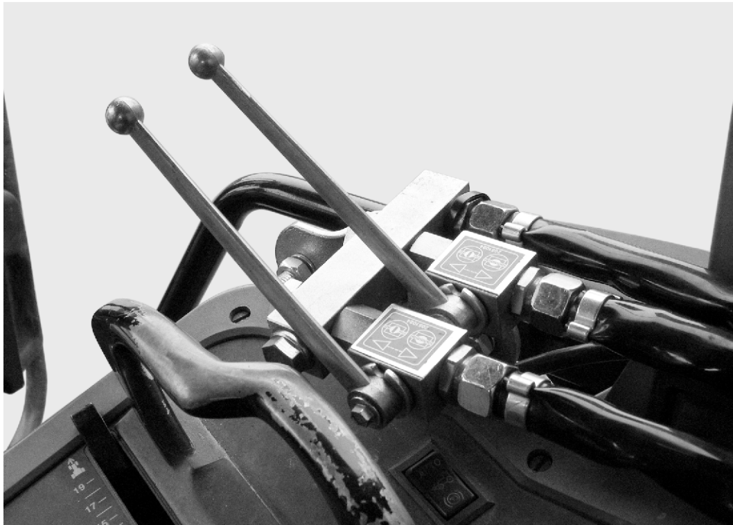
Pav. 28: Dviejų kanalų bloko sklendės valdymo įtaisas
