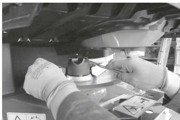
12.13 pav.: Gaubiamosios veržlės atlaisvinimas
