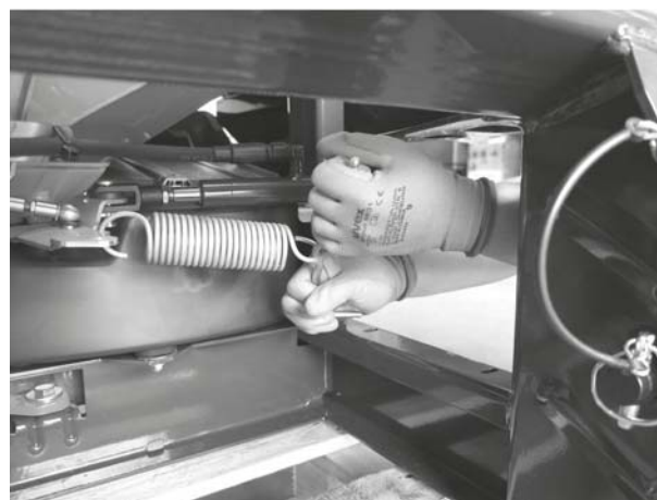
12.6 pav.: Spyruoklės atkabimas
