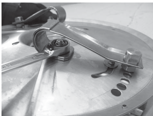
12.22 pav.: Varžto šalinimas
