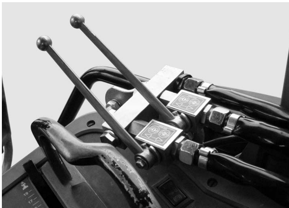
7.12 pav.: Dviejų eigų bloko sklendės valdymo įtaisas
