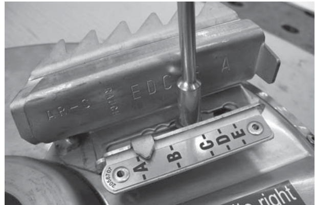
12.27 pav.: Barstomojo disko išmetamoji mentelė
