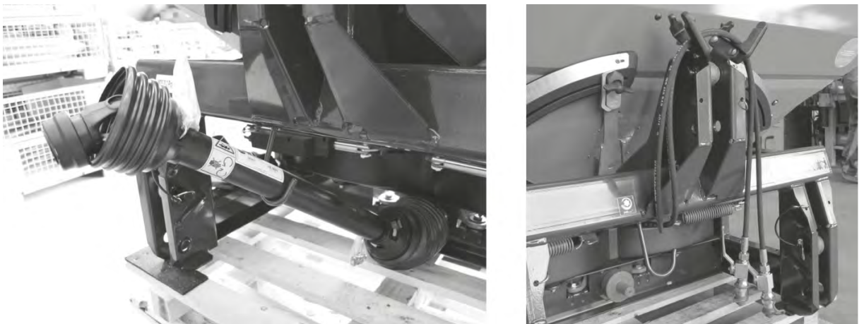
Фиг. 62: Място за съхранение на карданния вал, на кабелите и на хидравличните маркучи
