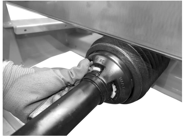
Obr. 15: Zajištění krytu kloubového hřídele
