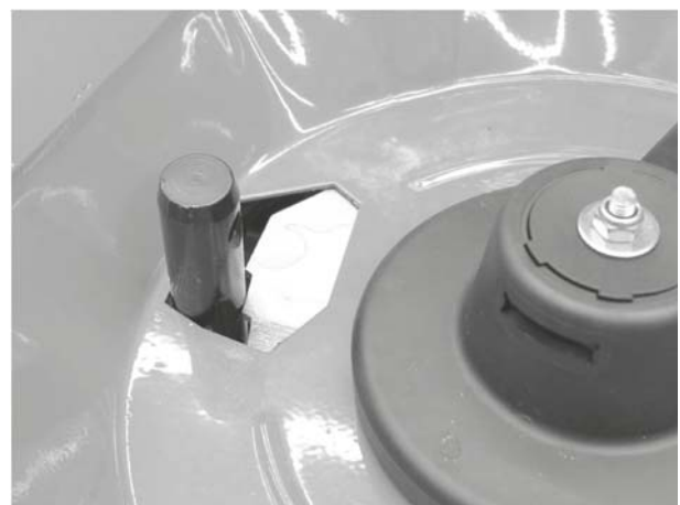
Obrázek 12.5: Čep spodní spojky v dávkovacím otvoru
