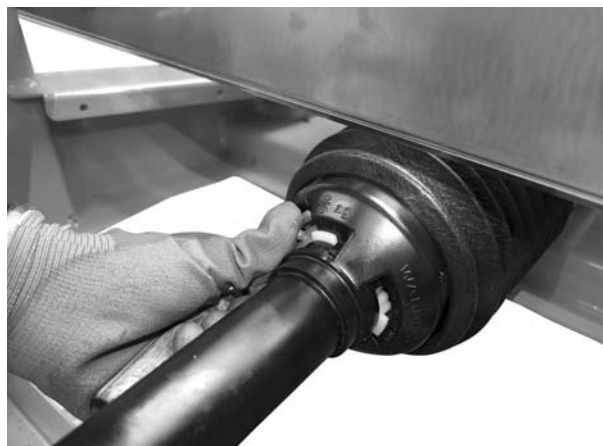
Obrázek 7.5: Zajištění ochrany kloubového hřídele
