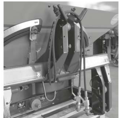
Obrázek 7.14: Uložení kloubového hřídele a hydraulických hadic
