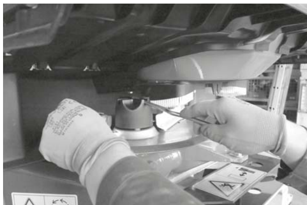
Obrázek 12.13: Povolení uzavřené matice
