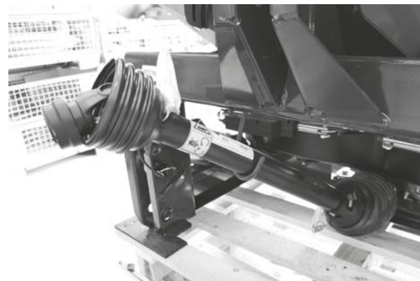
Obrázek 7.6: Držák kloubového hřídele
