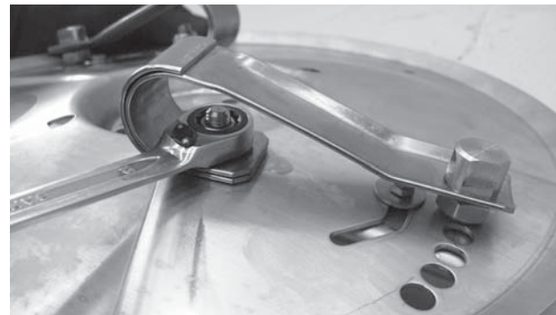
Obrázek 12.30: Upevnění ploché pružiny
