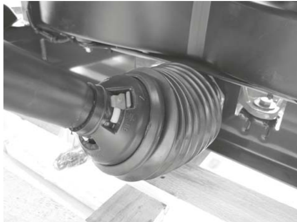
Obrázek 3.4: Ochrana kloubového hřídele
