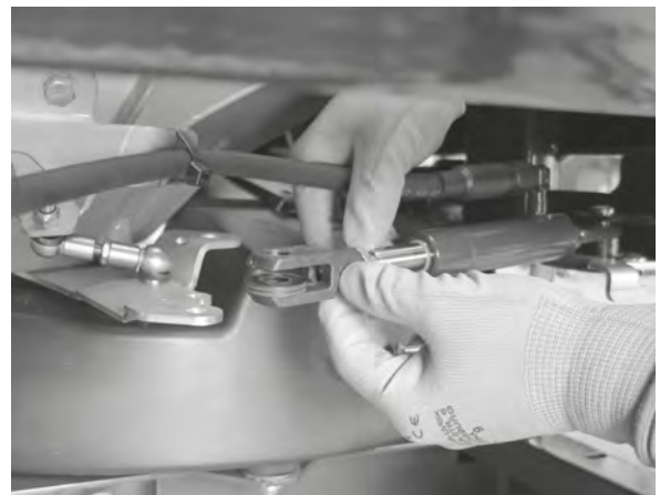
Afb. 71: Hydraulische cilinder naar buiten trekken
