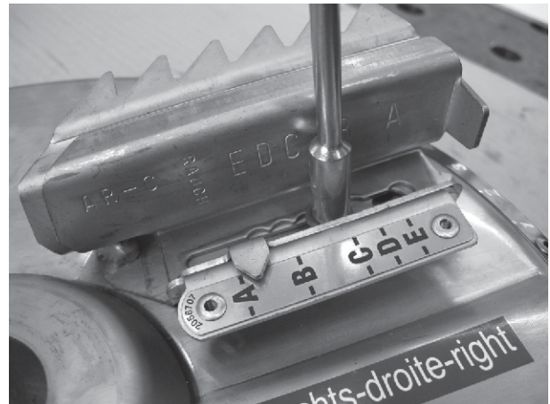
Afb. 85: Bevestigingspunten van de strooischoepen
