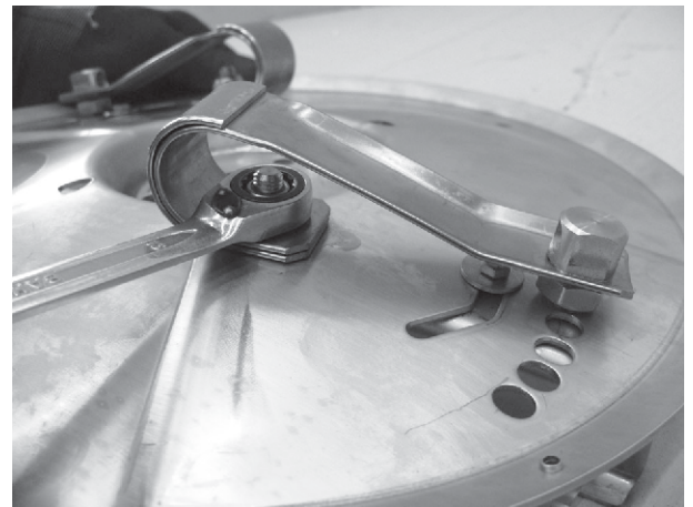
Afb. 94: Bevestiging van de platte veer
