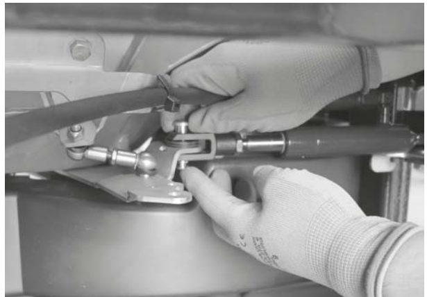
Afb. 12.7: Cilinder eruit nemen
