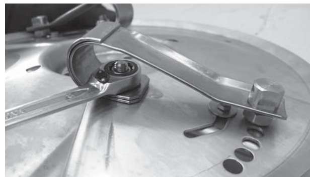
Afb. 12.30: Bevestiging van de platte veer
