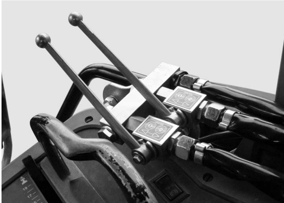
Afb. 7.12: Schuifbediening van de tweewegseenheid
