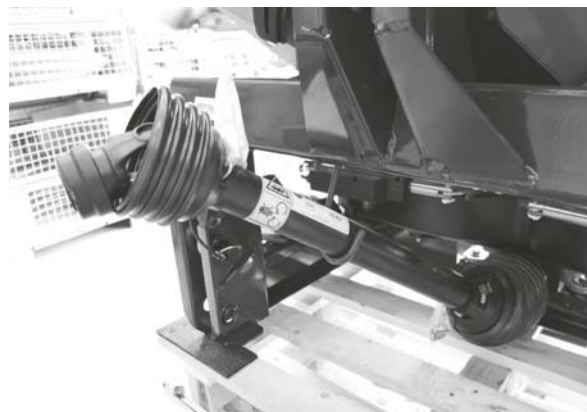
Afb. 7.14: Wegleggen van de aftakas en de hydraulische slangen
