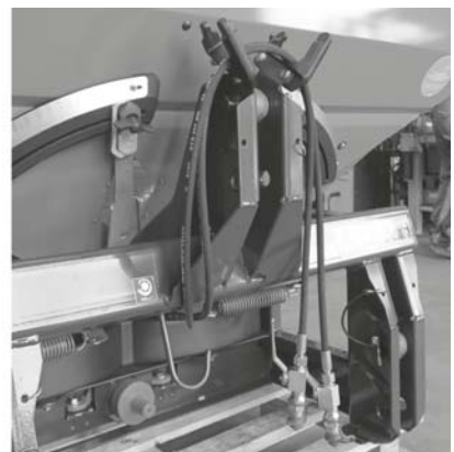
Afb. 7.14: Wegleggen van de aftakas en de hydraulische slangen
